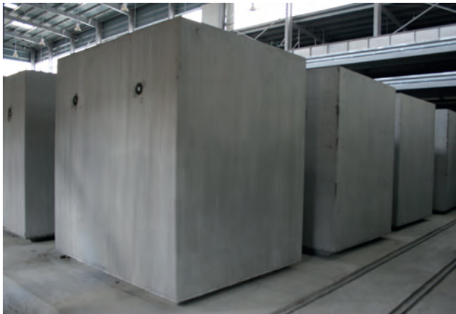
Крупноформатные элементы размером 2000 x 1500, 2000 x 2000, 2000 x 2500 и 2500 x 2500 мм в промышленном масштабе изготавливаются на заводе Amiantit Oman Concrete Products LLC
